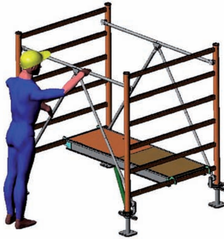
5 Mise en place de la diagonale et verrouillage des vérins imperdables
