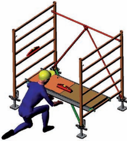
4 Mise en place d'un plateau à trappe auto rabattable et verrouillage anti-soulèvement automatique
