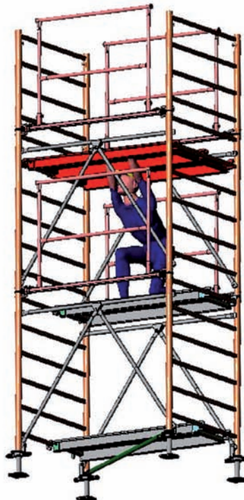
11 Mise en place de deux plateaux pour le dernier plancher
